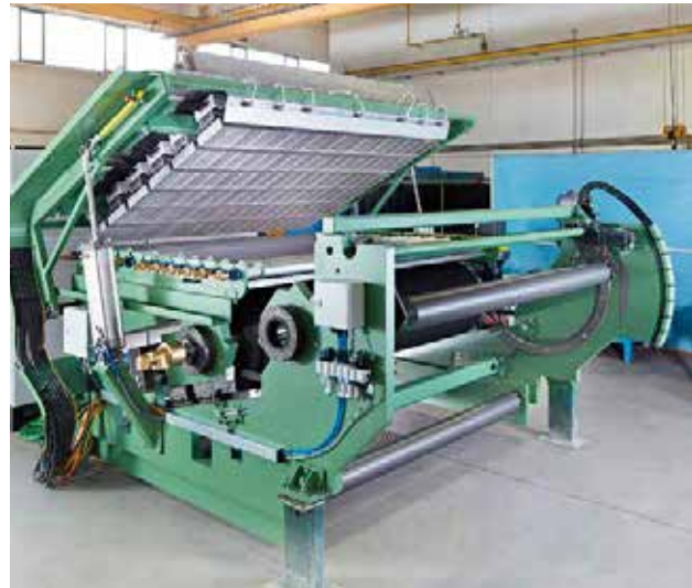
用於壓花機的 KRELUS 紅外線預熱系統（KRELUS infrared preheating for embossing machines） 資料來源：Kampf LSF GmbH，德國 Laussig
