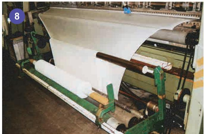
8 兩具10000S熱風機及1.2米長節省空間的管狀噴嘴，配上ASO吹風機，吹乾水織機織出的布匹。
