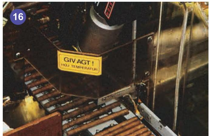
將HOTWIND "S" 熱風機用在局部吹乾雪茄煙之黏合部份，可在高速通過下，以恰當的熱風進行噴注吹乾。
