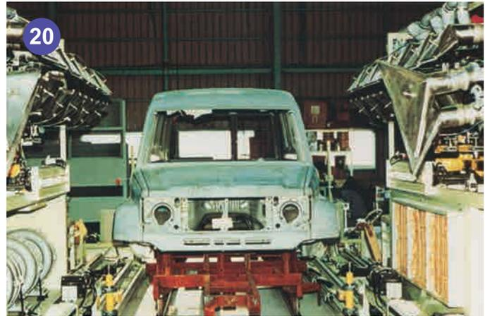
20 把二十八具10000S熱風器用在加速硬化膠著層。汽車接點使用黏膠替代點焊，可保證接著處不生鏽。
