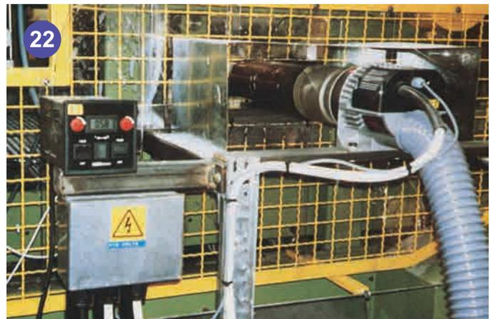
22 兩旁各置一具10000S熱風器及1.2米長管狀噴嘴，用熱風防止層壓玻璃料黏在輸送帶上，在加熱過程使用KSP雙控保證精確度。
