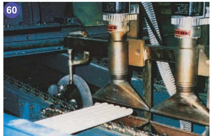
一具5000熱風器及ASO吹風機用於加熱光管端，其作用在於膠合前先清除塗層。
