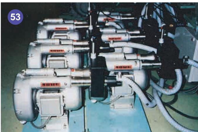
六具ROBUST鼓風機配上風量開關制，吹風機之空氣由氣動制關上後，可以立刻阻斷熱氣流。
