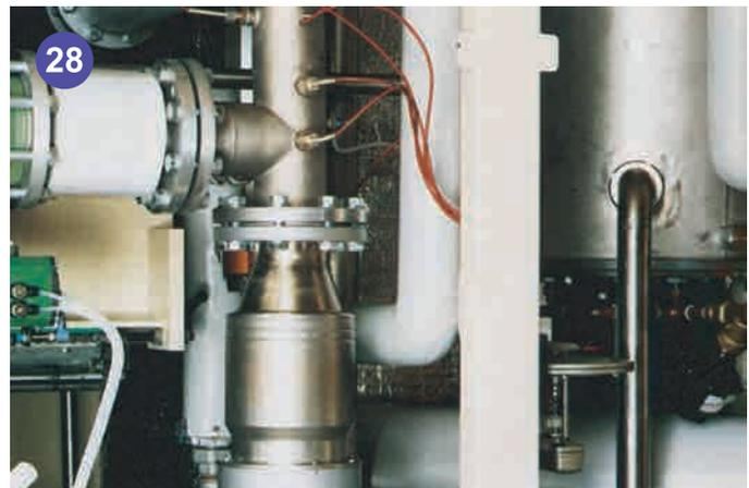
28 自動清洗機配一具40000熱風器及AS0吹風機。現已使用鹼性溶液清潔劑替代含有FC的清洗器。用熱風來吹乾清洗後的零件。
