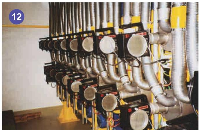
12 二十具HOTWIND“S”用於試驗球型軸承之設備，以不同之溫度及速度測試球型軸承之使用壽命。
