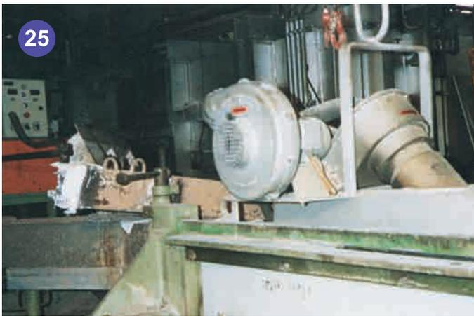
25 把一具40000熱風器及AS0吹風機用在加熱鋁擠壓機。在鑄造工廠熱風用於吹乾沙粒及燒掉聚苯乙烯芯片。
