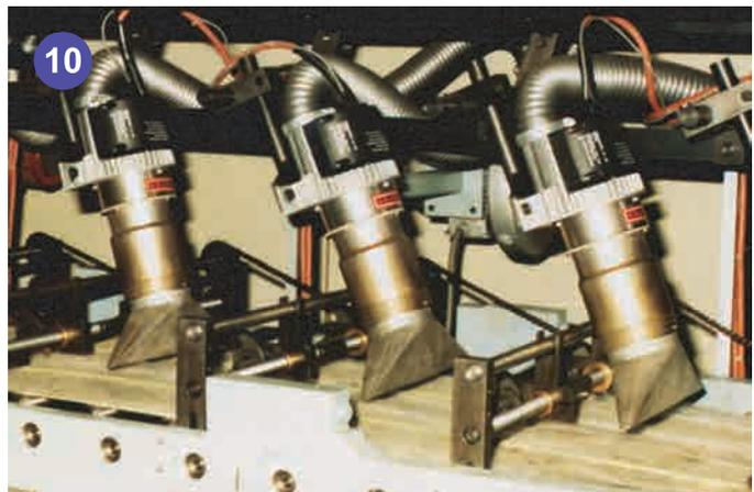
10 熱風裝設連一字形噴嘴在高速輸送下可吹乾及加強信封貼口之黏性。
