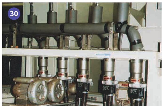
30 把五具5000發熱器裝置於加熱管狀的凹槽，一束塗料鋼線經過加熱管時可以熔化在一起。
