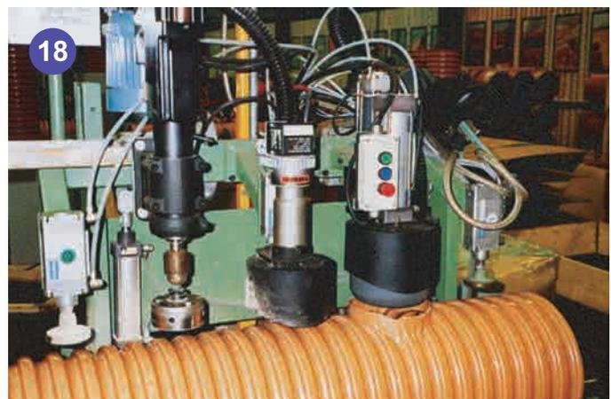
將一具5000熱風器及ROBUST吹風機做為加熱PVC輸送管，軟化材料使其易於形成分岐口。
