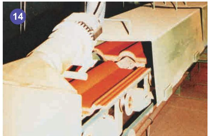
吹乾工序的隧道上配有六具10000S發熱器及兩具ASO吹風機，使用熱風機吹乾在高速通過的屋頂用瓦片上之塗層。
