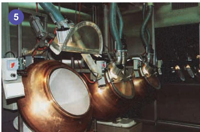
幾部5000熱風器配上AS0吹風機進行吹乾及弄圓滑藥丸、藥片、糖果及其他塗料。KSR用作準確控制溫度。
