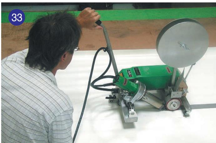
33 將50mm寬的加強貼帶，焊在卡車頂棚上，UNIMAT保證一個高效率焊接。
