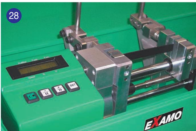
EXAMO應用於防水膜焊縫品質的切片，測試其剝離力及拉力。
