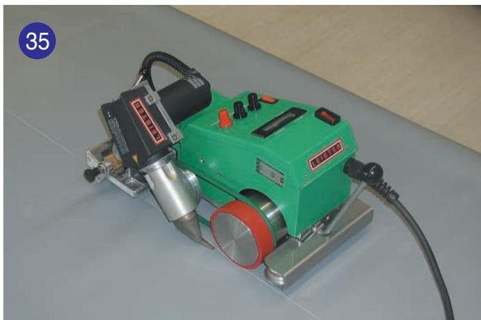
35 UNIPLAN用在卡車帆布頂棚的重疊焊縫，焊接速度最高可達7米/分鐘(23英尺/每分鐘)。
