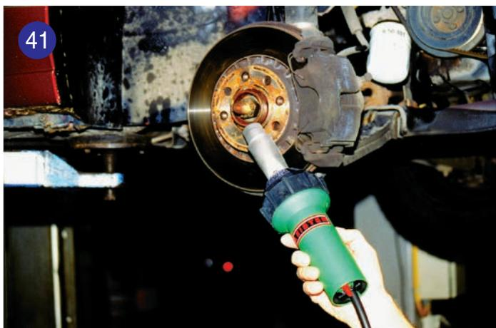
41 培林及傳動另件拆除前之加熱以LEISTER工具取代火焰是最好的選擇。
