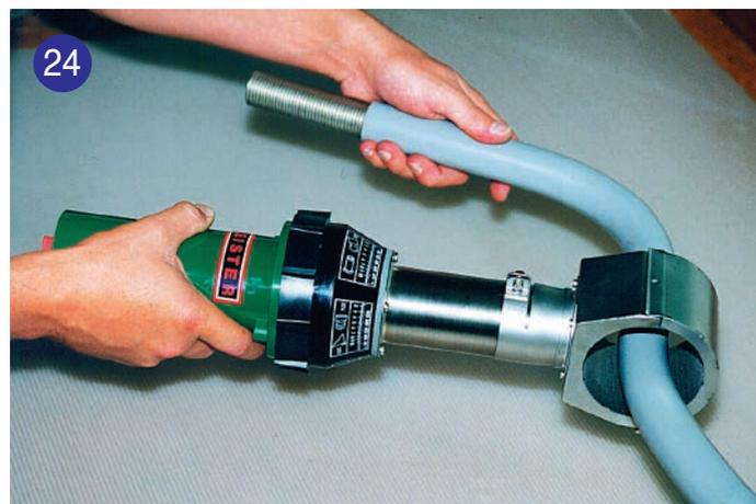
24 您有管材等的加熱工具，可交由Leister的熱風工具來幫您。
