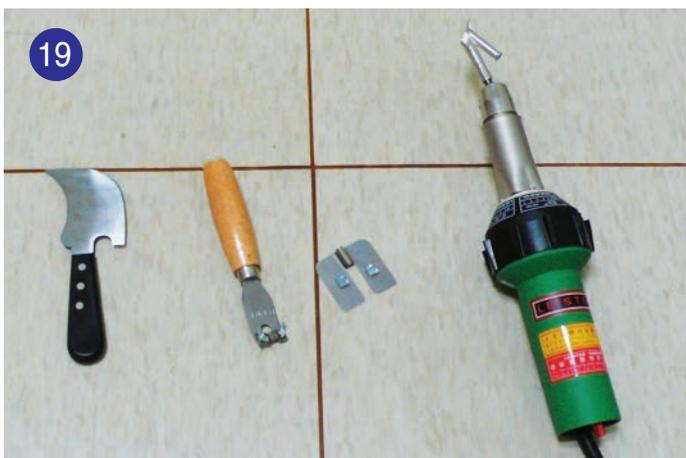
19 型號TRIAC配合5mm圓拖嘴、壓輪、焊條刮平刀及挖槽器，用於地板焊接封面。
