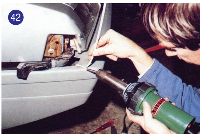
42 汽車接縫的補錫及填縫膠乾燥LEISTER工具是你的好幫手。
