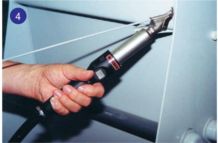
WELDING PEN R具有PID溫控，液晶顯示，配合固定及拖焊雙用焊嘴，是一把最強的焊接機。
