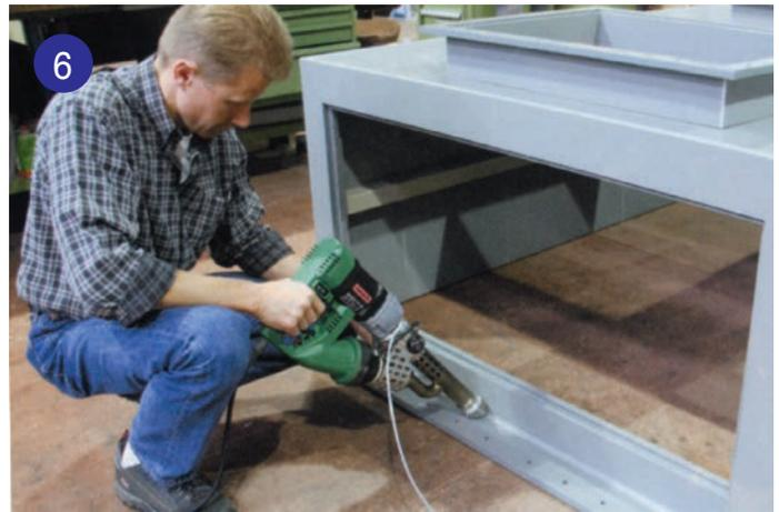
輕型壓出式焊機FUSION 3C。
