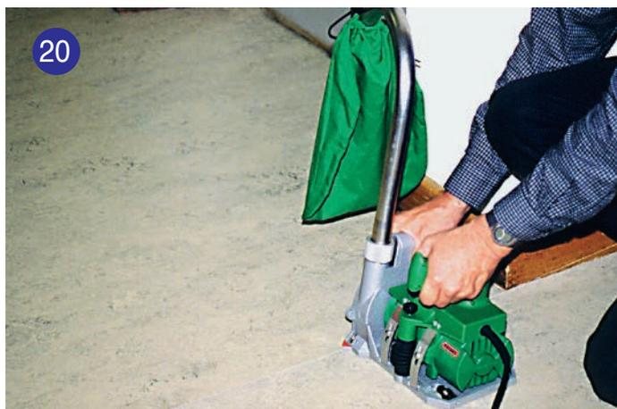
20 新式的GROOVER切溝機附集塵袋，三輪平衡及電磁力之應用是現場工作智慧之結晶。
