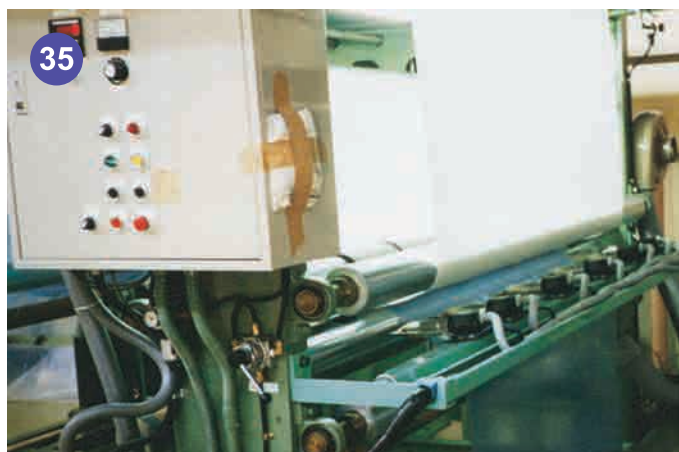
35 六具3000熱風器配70mm一字形噴嘴固定在塑膠貼合機上用作焊接不織布在EVA薄片上。(任何塑料貼合都可以)
