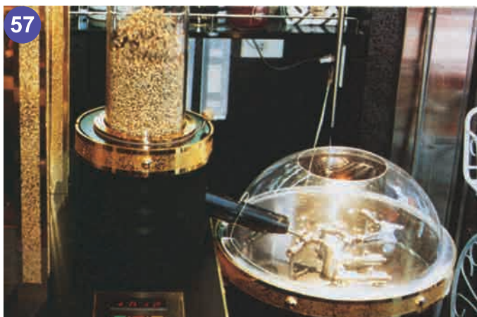
一具5000熱風器及ROBUST鼓風機供應熱風給咖啡烘焙機，熱風的溫度及烘焙時間可由客戶指定而輸入電腦。
