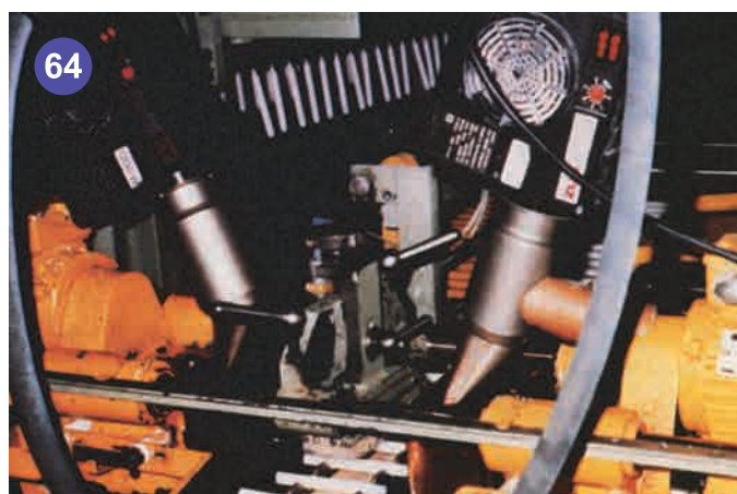
64 兩具HOTWIND “S” 熱風機配上一字形長150mm噴嘴。用在蠟燭切斷後的毛邊處理。
