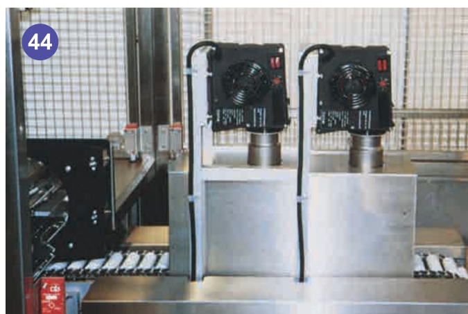
44 熱風設備配上兩具HOTWIND "S" 鼓風機及一具700熱風器用在收縮電池上的PE蓋。
