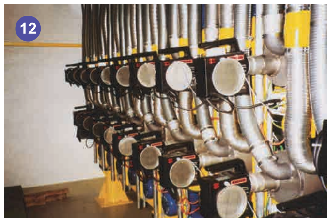
二十具HOTWIND“S”用於試驗球型軸承之設備，以不同之溫度及速度測試球型軸承之使用壽命。
