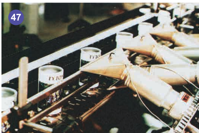
47 用KSR裝置控制下的六具5000熱風機，使用在收縮罐上的PE套管。在高速通過及準備控制下，保證完美收縮質量。
