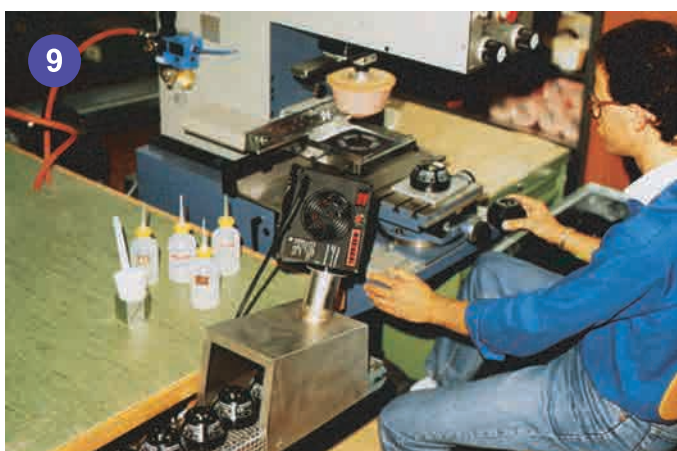
移印工序後，再利用HOTWIND“S”熱風機，配合特別噴氣槽熱乾印花圖案，熱風是使印刷油墨速乾的唯一辦法。
