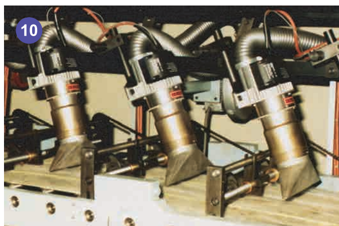
熱風裝設連一字形噴嘴在高速輸送下可吹乾及加強信封貼口之黏性。
