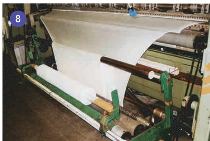
兩具10000S熱風機及1.2米長節省空間的管狀噴嘴，配上ASO吹風機，吹乾水織機織出的布匹。
