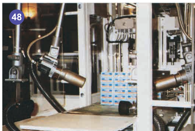
48 兩具5000熱風機用在收縮包裝薄膜在疊放的产品上，風量由SILENCE吹風機供應。
