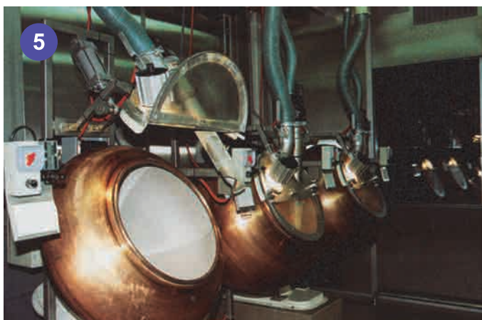
幾部5000熱風器配上ASO吹風機進行吹乾及弄圓滑藥丸、藥片、糖果及其他塗料。KSR用作準確控制溫度。
