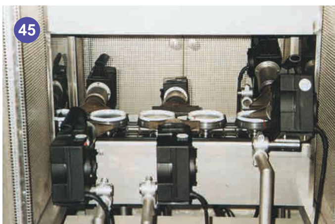
45 六具HOTWIND "S" 熱風機裝置在包裝機內，並於快速通過下收縮罐頂。
