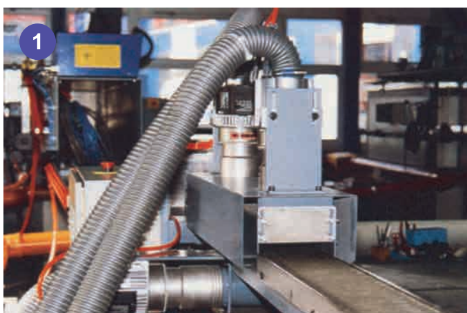
TYPE 10000S應用在清洗設備上快速吹乾及消毒。
