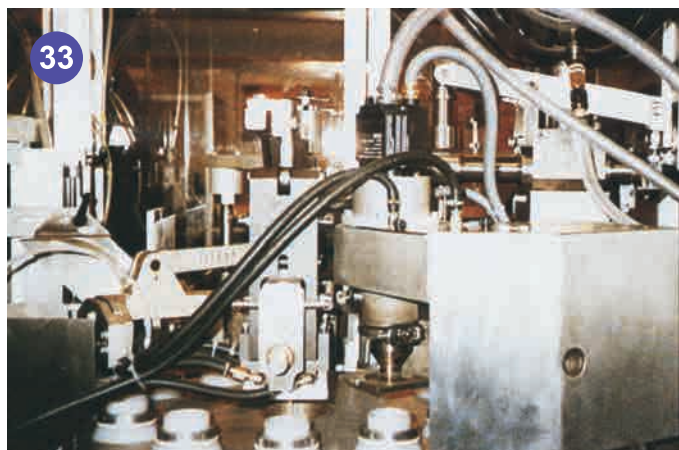
33 熔接膠管機配上一具3000熱風器及LONGLIFE吹風機，在牙膏、面霜及黏合劑載滿後，用熱風將管的末端熱熔封口。
