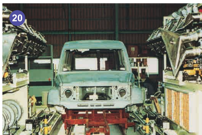
20 把二十八具10000S熱風器用在加速硬化膠著層。汽車接點使用黏膠替代點焊，可保證接著處不生鏽。
